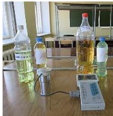
Рис. 3. Прибор для определения октанового и цетанового чисел: октанометр SHATOX SX-100M
