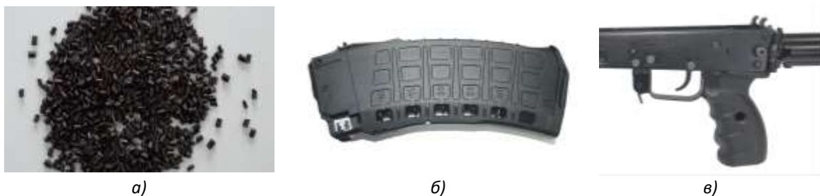
Рис. 8. Пластмасса в конструкциях стрелкового оружия: а) стеклоннаполненный полиамид; б) магазин автомата АК200; в) пистолетная рукоятка
