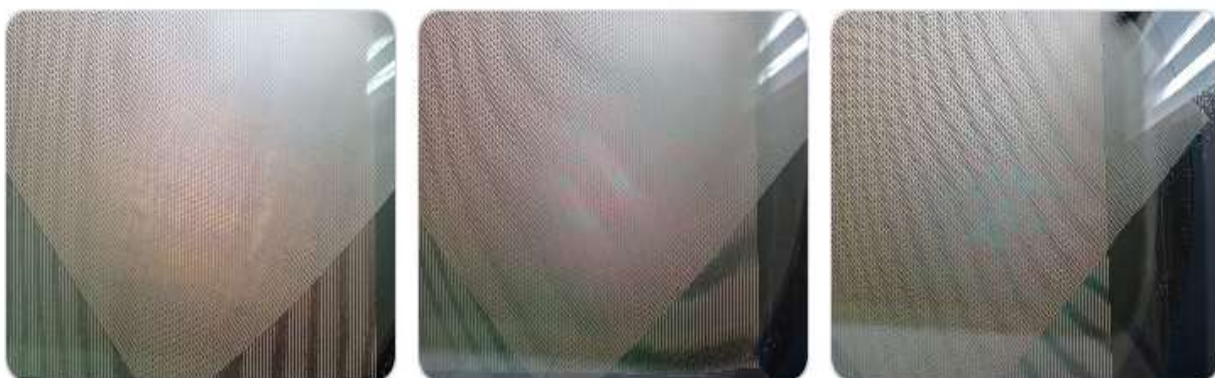
Рис. 3. Картина муаровых полос после введения одноволновой фазовой пластинки
