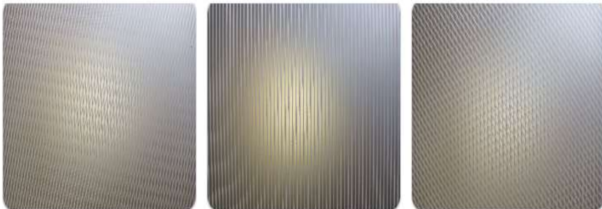
Рис. 2. Картина муаровых полос до введения в поле зрения одноволновой фазовой пластинки
